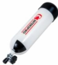
Montiert auf einer Interspiro Tragevorrichtung, zeigt das Flaschenventil der Divator Stahlflasche nach unten. Das hat den Vorteil, dass sich keine Ventile oder Schläuche hinter dem Kopf des Tauchers befinden, womit die Gefahr des Hängenbleibens deutlich verringert wird. Diese Ventil-nach-unten Konfiguration vereinfacht die Handhabung, zudem ermöglicht es dem Taucher das Ventil und alle Schläuche zu erreichen, selbst, wenn er einen bewegungseinschränkenden Trockenanzug trägt.
