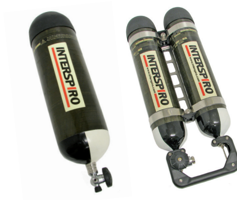
Volledige composietcilinder met kunststof voering - 3,4 l of 6,7 l - Enkele cilinder of cilinderpack - Onbeperkte levensduur - Ongeverfd
