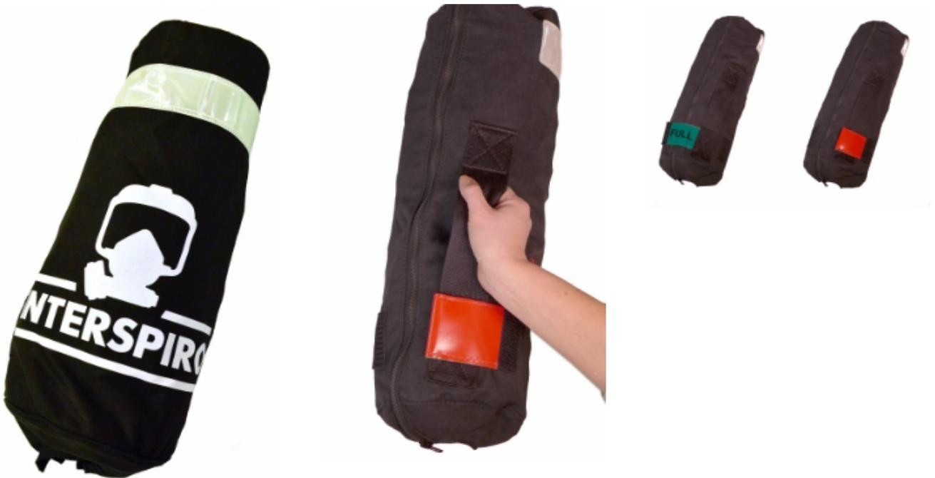
Die Flaschenhülle wurde aus Nomex hergestellt. Sie ist mit einem großen Reißverschluss, einem Tragegriff und einem Reflexionsband ausgestattet. Eine Klappe mit Klettverschluss mit grüner und roter Anzeige kann verwendet werden um anzuzeigen ob Flaschen wieder in Betrieb genommen werden können.
